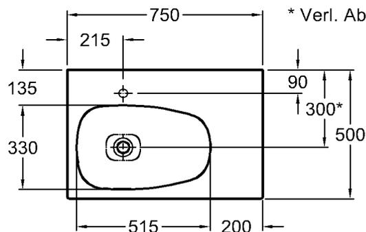
Abmessungen unterliegen den üblichen materialspezifischen Toleranzen von ± 2%. Die Katalogzeichnungen sind im Maßstab 1:20, falls nicht anders angegeben.
