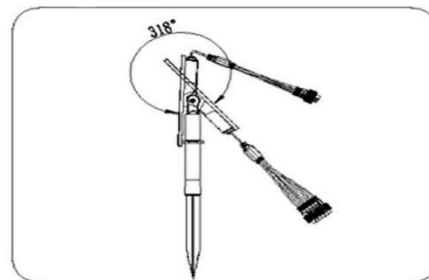
Drücken Sie den Knopf auf der Rückseite des Solar Panels und stellen den gewünschten Modus ein. Das Panel kann um 318° gedreht werden um einen bestmöglichen Sonnenstrahleneinfallswinkel zu bewirken
