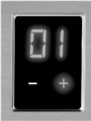
Während sich das Gerät im manuellen Modus befindet, wird der Timer-Modus durch Drücken der „Plus“-Taste aktiviert. Die Timer-Einstellung erfolgt zwischen 1 Minute und 4 Stunden mit den Plus- und Minus-Tasten im Timer-Modus. Auf- und absteigende Operationen können durch Gedrückthalten der Tasten durchgeführt werden. Nach der Installation zählt der Timerwert auf dem Bildschirm herunter, bis er „00“ erreicht.
