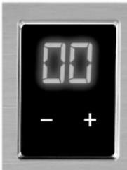
Wenn das Gerät zum ersten Mal mit Strom versorgt wird, beginnen die Zahlen „00“ auf dem Bildschirm zu blinken. Das Blinken erfolgt einmal pro Sekunde. Das Relais ist nicht in Übertragung. Solange keine Taste berührt wird, blinken die 00-Nummern weiter. Im Laufe der Zeit gibt es keine Erhöhung der 00-Nummern.
