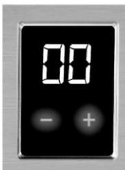
Wenn sich das Gerät im Standby-Modus befindet, führt das Drücken nur der Minus- oder nur der Plus-Taste keine Funktion aus.
