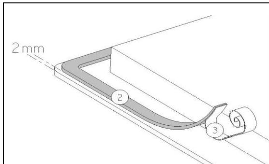
Die Dichtung (2) nach Abnehmen der Schutzfolie (3) mit 2 mm Abstand von der Außenkannte des Glases aufkleben.
