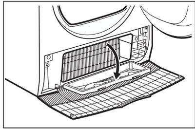
5. Entfernen Sie nach Bedarf die Flusen aus dem Kondensator und seinem Fach. Sie können einen Staubsauger mit Bürstenaufsatz verwenden.
