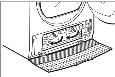
4. Klappen Sie den Kondensatordeckel nach unten.
