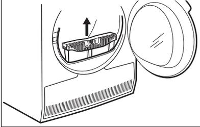
2. Öffnen Sie die Kondensatorabdeckung.
