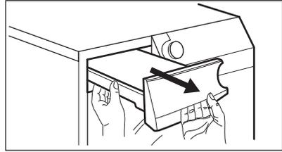
2. Ziehen Sie die Kunststoffverbindung heraus und entleeren Sie das Wasser in ein Waschbecken oder ein zweckmäßiges Behältnis.
