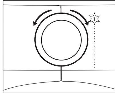
Wählen Sie das gewünschte Programm mit dem Programmwählschalter aus. Das Display zeigt die ungefähre Programmdauer an.
