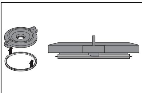
1. Ziehe die Dichtung **22** von der Unterseite des Deckels für den Mixbehälter **23** ab.
