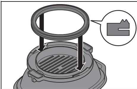
1. Ziehe die Dichtung **4** von der Unterseite des tiefen Dampfgaraufsatzes **3** ab.
