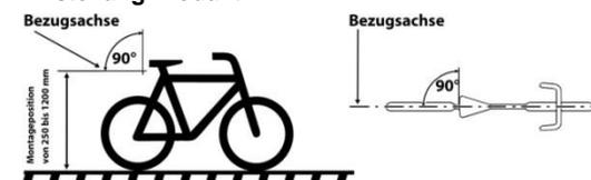
**Achtung:** Überprüfen Sie regelmäßig die richtige Einstellung und Anbauhöhe Ihres Rücklichtes. Das Rücklicht muss in einem Bereich von 250 bis 1200 mm über der Fahrbahn montiert werden. Es muss so angebaut und eingestellt werden, dass die Bezugsachse parallel zur Fahrzeuglängsmittlebene und parallel zur Fahrbahn liegt (siehe Abbildung).
