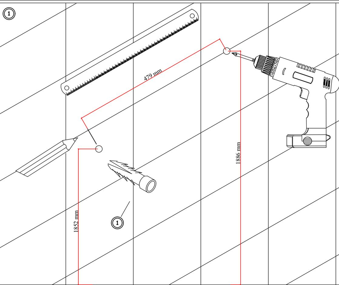
BOHREN SIE MIT EINEM SCHLAGBOHRER LÖCHER ENTSPRECHEND DER ANGEZEIGTEN ABSTÄNDE ZUR ANBRINGUNG DER AUFHÄNGUNGSELEMENTE. STECKEN SIE ANSCHLIESSEND DIE DÜBEL IN DIE LÖCHER.
