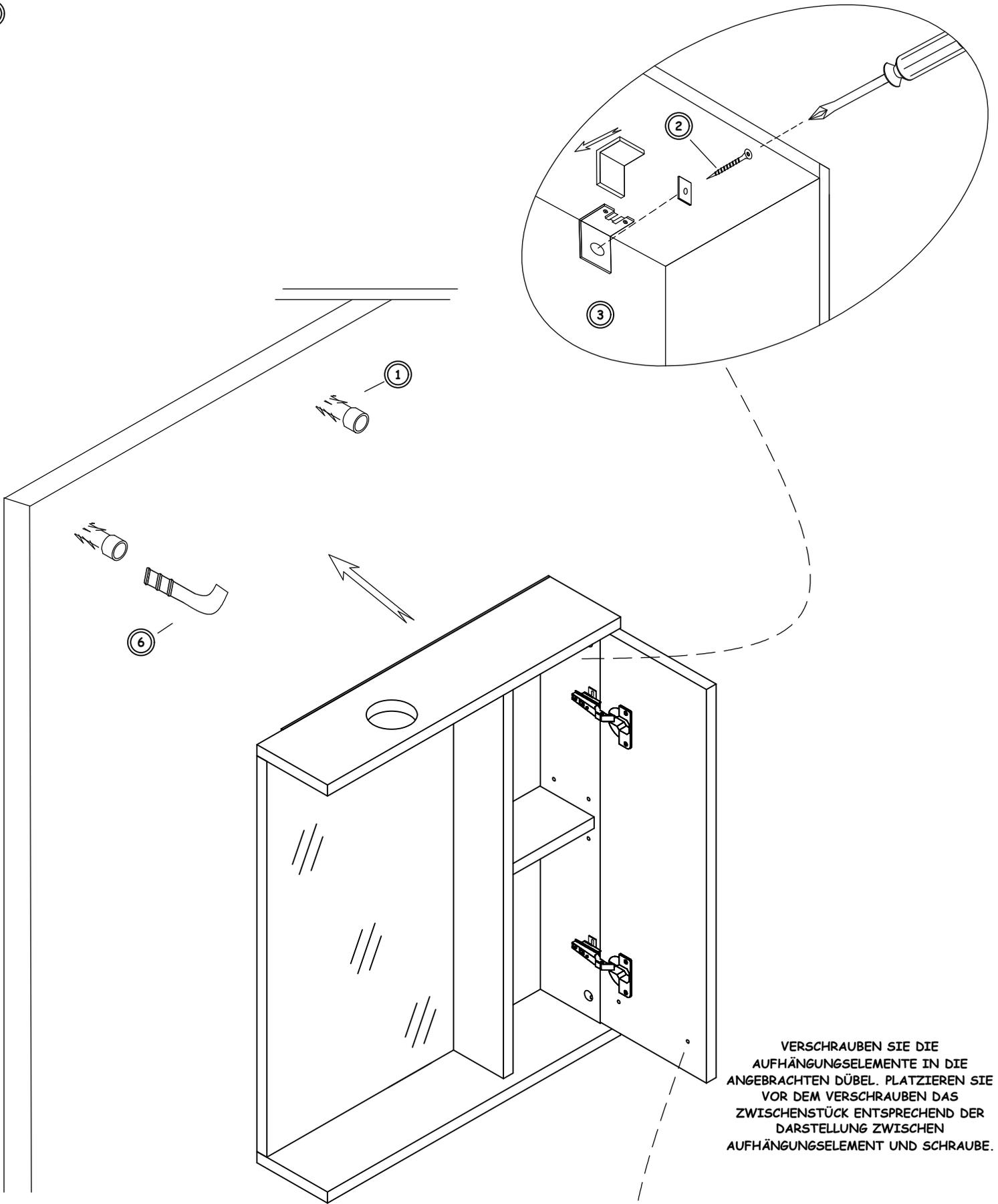
SCHRAUBEN SIE DEN SCHRAUBHAKEN IN DEN VORHER ANGEBRACHTEN DÜBEL. HÄNGEN SIE DAS AN DER RÜCKSEITE DES SCHRANKS BEFESTIGTE AUFHÄNGUNGSELEMENT AN DEN HAKEN DES
