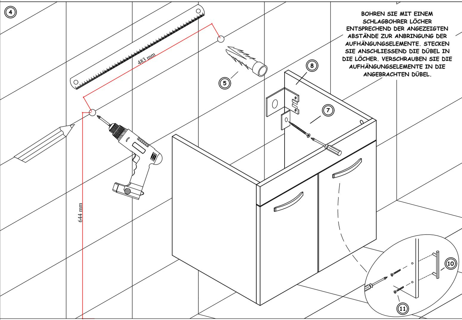
BOHREN SIE MIT EINEM SCHLAGBOHRER LÖCHER ENTSPRECHEND DER ANGEZEIGTEN ABSTÄNDE ZUR ANBRINGUNG DER AUFHÄNGUNGSELEMENTE. STECKEN SIE ANSCHLIESSEND DIE DÜBEL IN DIE LÖCHER. VERSCHRAUBEN SIE DIE AUFHÄNGUNGSELEMENTE IN DIE ANGEBRACHTEN DÜBEL.
