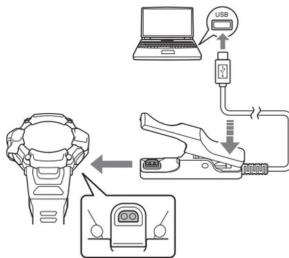
1. Schalten Sie Ihren Computer oder ein anderes Gerät mit einem USB-Anschluss (Stromquelle) ein, und schließen Sie das Ladekabel daran an.
