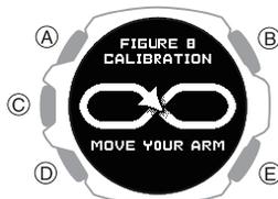
Wenn der oben aufgeführte Bildschirm angezeigt wird, bewegen Sie den Arm in Form einer liegenden 8, wie in den folgenden Abbildungen dargestellt.
