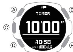
5. Verwenden Sie (A) und (D), um die Startzeiteinstellung des Timers zu ändern.
