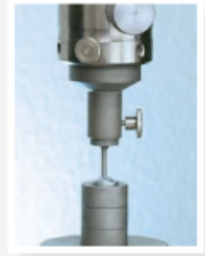
Test Restnietdornverriegelung Mandrel retaining test Essai de résistance au désassemblage de la tige
