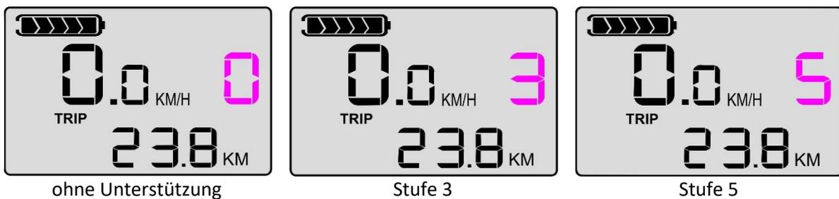
Zum Anwählen der Unterstützungsstufe Drücken Sie die Plus-Taste um eine Stufe zu erhöhen oder die Minus-Taste um eine Stufe zu verringern. Die Stufen können gewählt werden von „0“ – keine Unterstützung bis „5“ – höchste Unterstützung.
