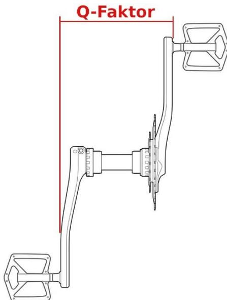
Durch einen zu geringen oder zu großen Pedalabstand (Q-Faktor) können Schädigungen an den Beinen auftreten. Es besteht die Gefahr, dass die Fahrer mit dem installierten Kurbelsatz Probleme haben.
