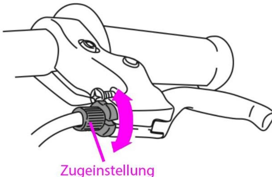
An jedem der Bremsgriffe ist eine Einstellschraube mit der die Zugspannung des Bremszuges feineinstellt werden kann. Drehen Sie diese Einstellschraube gegen den Uhrzeigersinn um die Zugspannung zu erhöhen und im Uhrzeigersinn um die Spannung zu verringern. An der Einstellschraube befindet sich eine Feststellmutter die im Anschluss verhindert, dass sich die Einstellung von selber verändert.
