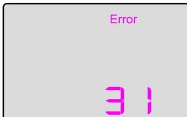
Tritt ein Problem mit dem elektrischen Antrieb, der Steuerung oder einem elektrischen Bauteil auf, wird dies über einen Fehlercode im Display angezeigt. Wenn ein Fehlercode auftritt muss das betroffene System oder Bauteil entsprechend überprüft werden.
