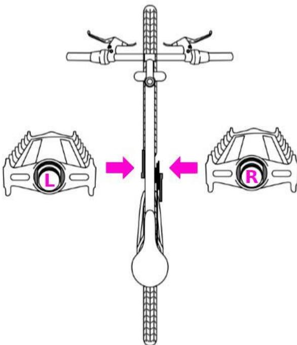
Die Pedale sind mit unterschiedlichen Gewinden ausgestattet. Deshalb sind die Pedale mit L bzw. R gekennzeichnet. Das mit L gekennzeichnete Pedal muss an der Kurbel auf der in Fahrtrichtung linken Seite des Fahrrads montiert werden. Das mit R gekennzeichnete Pedal muss an der Kurbel auf der in Fahrtrichtung rechten Seite des Fahrrads montiert werden.
