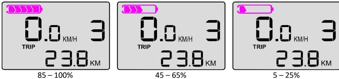
Die Anzeige für die Akku-Ladekapazität am Display zeigt Ihnen den Akkustand in fünf Stufen an. Sollte die Restkapazität nur noch 25% oder weniger betragen (Bild oben rechts), sollte der Akku bereits geladen werden.
