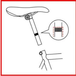
Auf dem Tauchrohr Ihrer Sattelstütze befindet sich eine „min insert“ Marke. Diese Markierung darf nicht sichtbar sein und zeigt so die Mindesteintauchtiefe Ihrer Sattelstütze im Sattelrohr an. Sollte dies nicht erfüllt sein, besteht die Gefahr, dass sich entweder das Tauchrohr der Sattelstütze oder das Sattelrohr Ihres Rahmens dauerhaft verformen.
