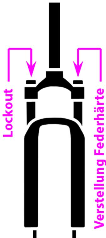
An der Federgabel kann die Federhärte einstellen werden. Drehen Sie die linke fork cap (Blick in Fahrtrichtung) in Richtung „+“ um die Federhärte zu erhöhen und in Richtung „-“ um die Federhärte zu verringern.
