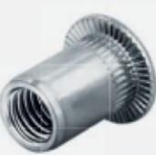
Rundschaft gerändelt wird verwendet, wenn eine Anwendung eines Sechskantschaftes nicht möglich ist. Generell ist die gerändelte Ausführung, im Bezug auf die zusätzliche Verdreh Sicherheit, der glatten vorzuziehen, speziell bei Bauteilen aus Kunststoff und weichen Materialien, jedoch auch bei harten Materialien.
