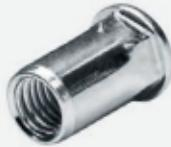
Eine optimale Verdreh Sicherheit wird durch den Teilechskantschaft sichergestellt. Der Teilechskant verhindert im Gegensatz zum Sechskantschaft ein irrtümliches Abschrauben nach dem Setzen durch einen Schlüssel (z.B. bei regelmäßigen Wartungen).
