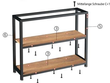
4 Nach Schritt 3 befestigen Sie bitte das Fachbord 4 mit den Stangen 9, 10 und 11.
