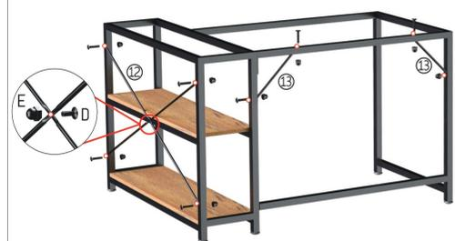
6 Richten Sie die Bretter 1 und 2 mit den Löchern aus und befestigen Sie sie mit langen Schrauben auf dem Fachboden, dann drehen Sie die Schrauben der Tischfüße, um den Computertisch waagrecht zu stellen.
