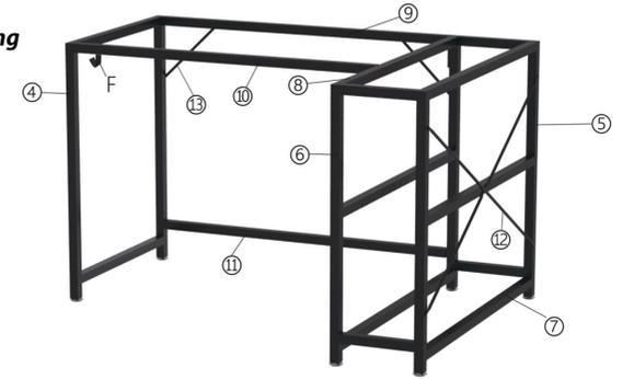
1 Bitte drehen Sie die Schrauben der Tischfüße in die Einlegeböden 4, 5 und 6.
