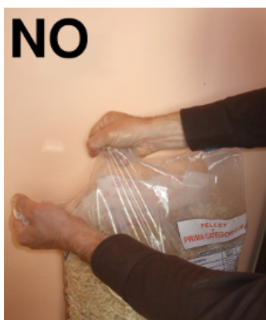
Fig. 88 - Fehlerhafte Öffnung des Pelletsacks
