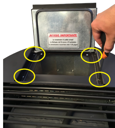
Fig. 68 - Entfernen der Schrauben
