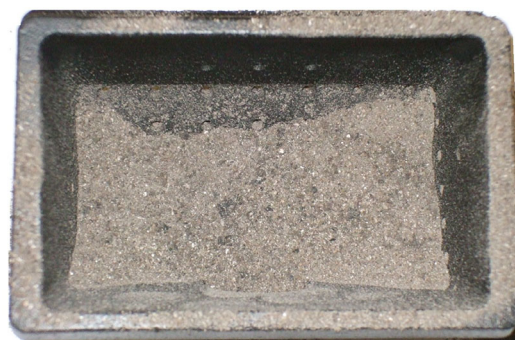
Fig. 94 - BEISPIEL VERSCHMUTZTE BRENNSCHALE
