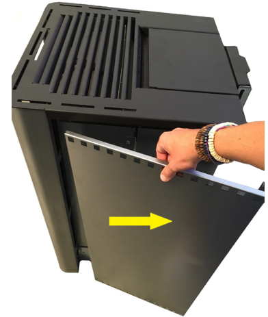
Fig. 71 - Entfernen der Seiten
