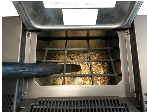
Fig. 96 - Reinigung Tank und Schnecke
