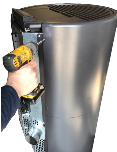
Fig. 62 - Die hinteren Schrauben entfernen.
