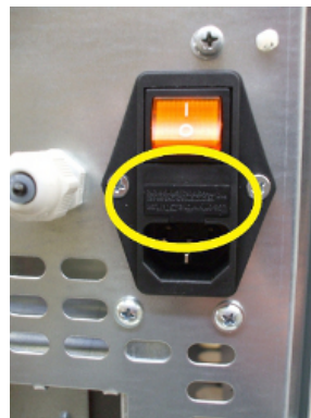
Fig. 104 - Abdeckklappe mit Sicherungen, die ausgewechselt werden müssen
