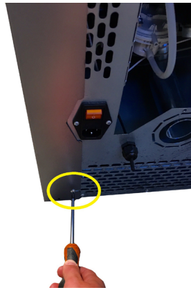
Fig. 70 - Entfernen der Schrauben
