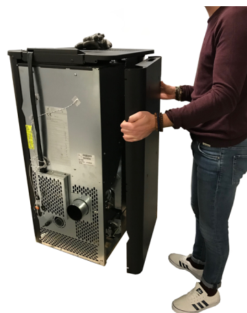
Fig. 44 - Abnehmen der Seitenwand
