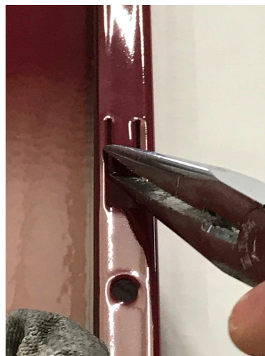
Fig. 41 - Biegen der kleinen Zungen nach außen
