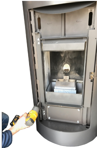
Fig. 60 - Schrauben und Profile (rechts und links) entfernen.
