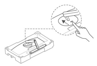
▲ Vergewissern Sie sich vor dem Anbringen des Ständers, dass der Träger auf der Rückseite des Monitors frei von Metallteilen ist, anderenfalls kann ein Kurzschluss auftreten.
