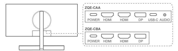
Öffnen Sie die Schutzabdeckung unten an der Monitorrückseite, um die Anschlüsse zu sehen. Je nach Kabeltyp können Sie den Monitor an ein Gerät wie z. B. einen Computer anschließen.
