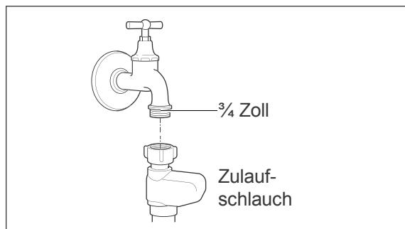
Für die Wasserversorgung benötigen Sie einen Wasserhahn mit einem  $\frac{3}{4}$  Zoll-Schraubanschluss.
