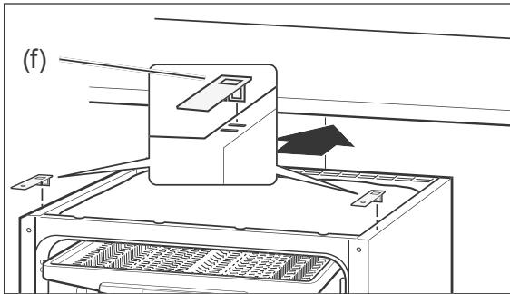
4. Stecken Sie beide Montagewinkel (f) in die vorderen Schlitze an der oberen Seite des Geschirrspülers, um später den Geschirrspüler an die Arbeitsplatte anzuschrauben zu können.
