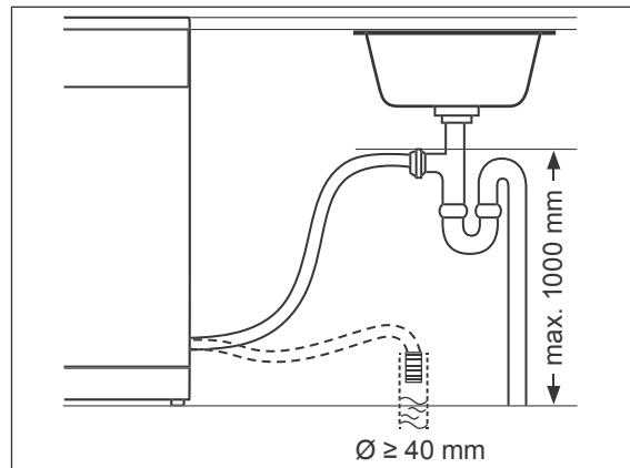
Sie können den Auslass des Ablauchschlauchs auf zwei verschiedene Weisen anschließen lassen:
