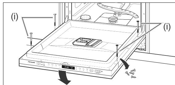
7. Entfernen Sie die 4 Schrauben an der Innenseite der Tür. Schrauben Sie die Möbelfrontplatte an diesen Positionen mithilfe der beiliegenden 4 Schrauben (i) fest.
