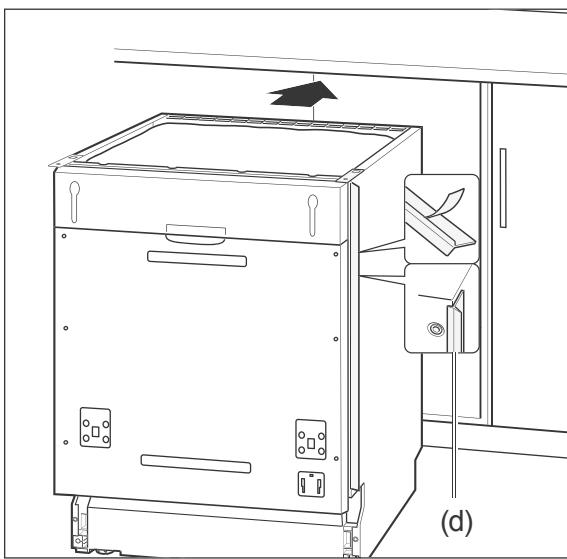
5. Entfernen Sie die Schutzfolien von den seitlichen Abschlussprofilen (d).
