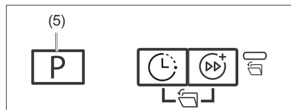
2. Halten Sie die Taste (5) so lange gedrückt, bis im Display der aktuelle Härtegrad angezeigt wird: H1 bis H6.
