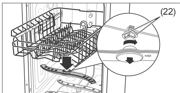
3. Der obere Sprüharm ist mit einem Bajonettschluss befestigt. Zum Abnehmen des Sprüharms halten Sie die beiden gezackten Bajonetegriffe (22) fest und drehen Sie den Sprüharm im Uhrzeigersinn ab.
