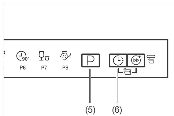
2. Drücken Sie innerhalb von 60 Sekunden nach dem Einschalten 5 Sekunden lang die Taste P (5).
