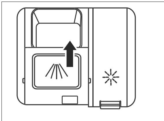
4. Drücken Sie den Deckel der Kammer zu, sodass der Verschluss (25) wieder einrastet.
