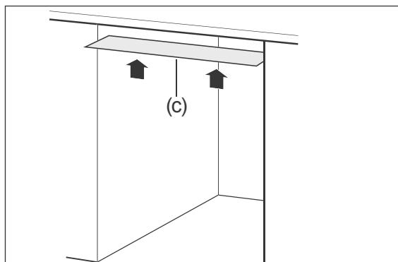
3. Kleben Sie die beiliegende Schutzfolie für Kondenswasser (c) auf die Unterseite der Arbeitsplatte. So vermeiden Sie Schäden an der Arbeitsplatte aufgrund heißer Dämpfe, die bei geöffneter Tür aus dem Geschirrspüler strömen
