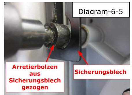
Arbeitstisch -mit Sicherungsblech- ganz nach oben ziehen und mit Fixierknopf 1 und 2 oben festklemmen. (6-3)
