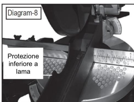
Rimuovere il proteggi-lama inferiore. Terminato il lavoro inserire nuovamente il proteggi-lama
