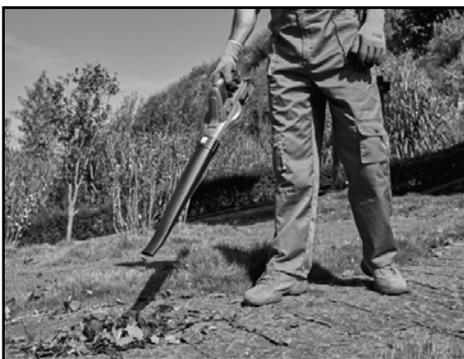
Halten Sie das Gerät mit einer Hand fest und führen Sie den Blasvorgang durch langsames Bewegen aus. Wenn Sie um Gebäude, große Steine oder Fahrzeuge herum blasen, richten Sie die Düse von ihnen weg. Wenn das Gerät in einer Ecke betrieben wird, startet es in der Ecke und bewegt sich dann in den weiten Bereich.
