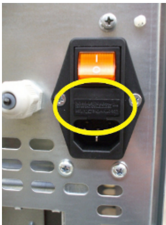
Fig. 88 - Abdeckklappe mit Sicherungen, die ausgetauscht werden müssen
