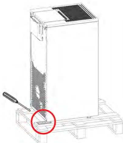
Fig. 1 - Entfernung der Halterungen
