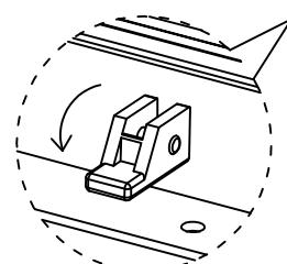
Lösen Sie die Verriegelung
