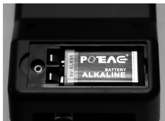
Riposizionare nel vano una nuova pila 9V
