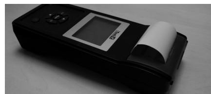
C. Laat een klein stukje papier uit het compartiment komen en druk op het transparante klepje om dit te sluiten.
