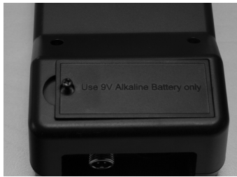
Desatornillar totalmente el compartimiento de las pilas
