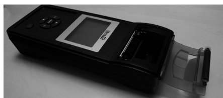
A. Ouvrir le couvercle transparent.
