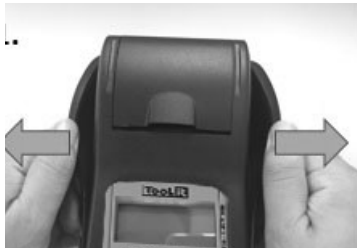
Entfernen Sie die Schutzabdeckung.
