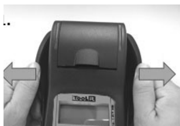
Verwijder het beschermende omhulsel
