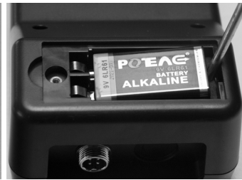
Retirar la pila realizando una palanca con un destornillador
