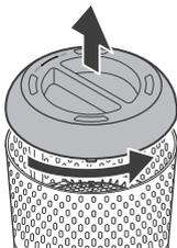
2. Drehen Sie den Griff an der Unterseite des Produkts im Gegenuhrzeigersinn und ziehen Sie den Filterdeckel heraus.
