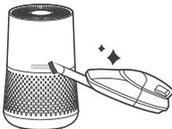
Intelligenter Sensor (Staubsensor) mit Staubsauger reinigen.
