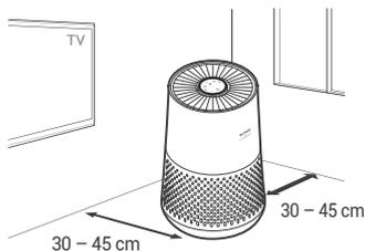
**Achten Sie darauf, dass der Luftreiniger 30 bis 45 cm Abstand zu Fernsehgeräten, Rundfunkgeräten und anderen elektronischen Geräte hat.** Elektromagnetische Störungen von bestimmten Elektronikerelementen können sonst Fehlfunktionen verursachen.
