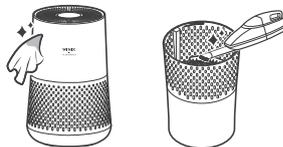
Wischen Sie die Außenflächen mit einem weichen, mit lauwarmem Wasser befeuchteten Tuch ab. Wischen Sie die Außenflächen anschließend einem sauberen, trockenen Tuch ab.
