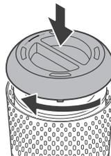
5. Drehen Sie den Griff nach der Filtermontage im Uhrzeigersinn, um den Filterdeckel zu schließen.
