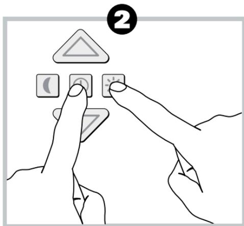
➋ Grenzwert der Sonnenautomatik einstellen: Betätigen Sie kurz gleichzeitig die [Sonnen]- und [Uhr]-Taste. Die Speicherung des Grenzwertes wird durch kurzes Aufblincken der Sonnen-LED bestätigt.
