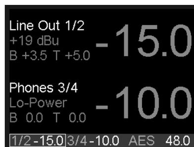
Um trotz fehlender Pegelanzeige eine Übersteuerung durch Volume, PEQ oder B/T erkennen zu können, sind die beiden großen Volume-Zahlen mit der Over-Erkennung der analogen Ausgänge gekoppelt. Sie wechseln ihre Farbe bei Übersteuerung (+2,5 dBFS) zu rot.
