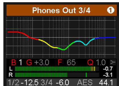
Mit Druck auf Encoder 2 springt der Cursor in die Parameterzeile, alle Werte nun in weißer Farbe. Jetzt ist es möglich alle Parameter durch Drehen der drei Encoder einzustellen. Der Volume-Knopf verändert den Gain, Encoder 1 die Frequenz, Encoder 2 die Güte (Q). Alle Änderungen werden in Echtzeit als Frequenzgang dargestellt, was es sehr einfach macht die gewünschten Resultate zu erzielen.
