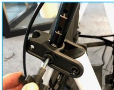
Ist der Griff in der gewünschten Höhe, schieben Sie die Schraube durch das Rohr und die Griffstange und ziehen Sie sie fest.
