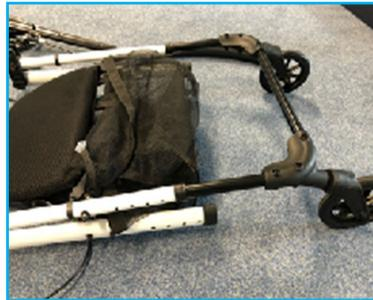
Der Bügel mit den Vorderrädern wird in die runden Rohe des Rahmens geschoben.
