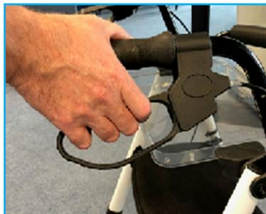
Betriebsbremse: So bremsen Sie die Fahrt ab. Betätigen Sie immer beide Bremsen gleichzeitig.
