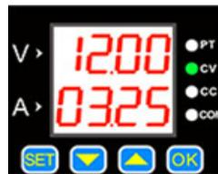
Drücke „OK“ um den Ausgang an und auszuschalten. Wenn die Laststrom unter dem gesetzten maximal Strom liegt, dann wechselt der Ausgang zum Konstantspannungsmodus und CV leuchtet auf.
