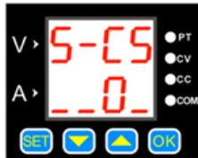
Der Menüpunkt beinhaltet das Kommunikationsprotokoll. Hier bedeutet die „0“ das einfache Kommunikationsprotokoll und „1“ das Modbus Kommunikationsprotokoll.
