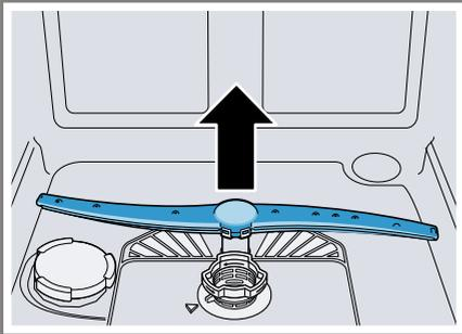
3. Unter fließendem Wasser die Ausstrittsdüsen der Sprüharme auf Verstopfungen prüfen und gegebenenfalls Fremdkörper entfernen.
