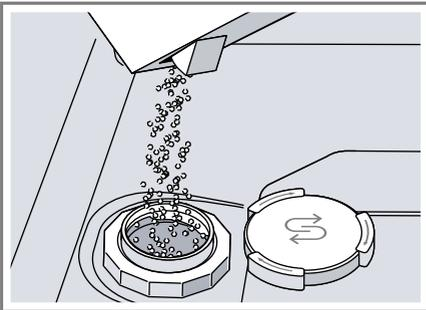
Den Vorratsbehälter komplett mit Speziessalz füllen. Das Wasser im Vorratsbehälter wird verdrängt und läuft ab.
