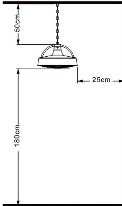
2. Befestigen Sie nun die mitgelieferte Befestigungskette am Halterungshaken, indem Sie ein Ende der Kette mit einem Karabiner im Halterungshaken einhängen.
