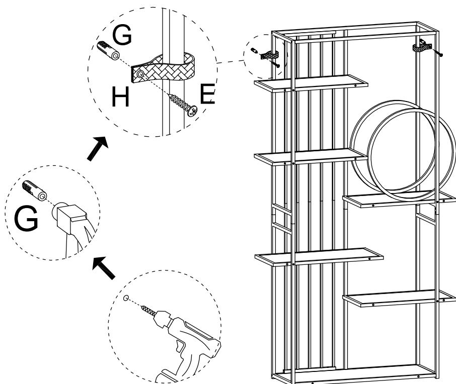
DE:ACHTUNG: Zur Sicherheit und Stabilität empfehlen wir Ihnen, die Kippsicherungszubehör an der Wand zu befestigen, um ein Umkippen, Verletzungen und Sachschäden zu verhindern.
