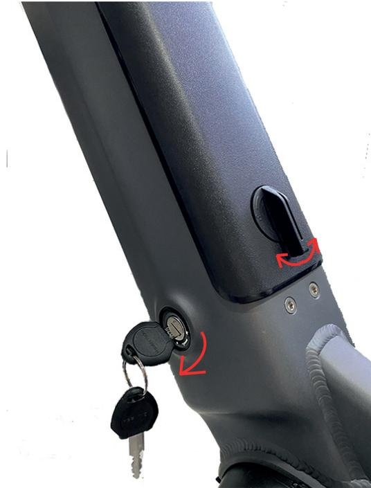
2. Durch Drehen des Schlüssels können Sie das Batteriefach entriegeln und bei Bedarf die Batterie entnehmen.
