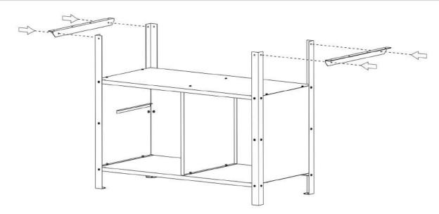
Befestigen Sie die beiden Verbindungswinkel (2) wie abgebildet mit je zwei Schraubensets (23) an den Tischbeinen auf der linken sowie rechten Seite der Werkstattbank.
