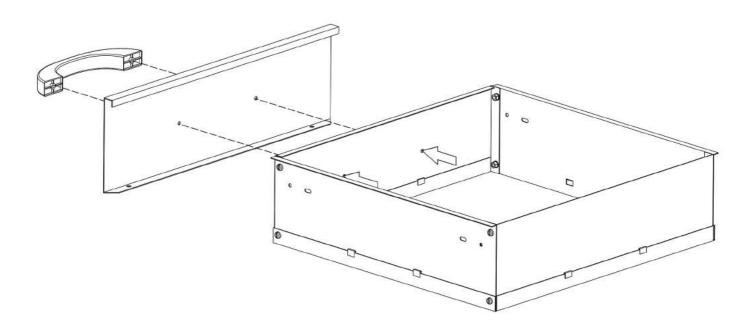
Schrauben Sie die Schubladenblende (14) und den Schubladengriff (20) mit Hilfe von zwei Schneidschrauben (25) wie abgebildet an die Schubladenfront. Ziehen Sie alle Schrauben jetzt fest an.
