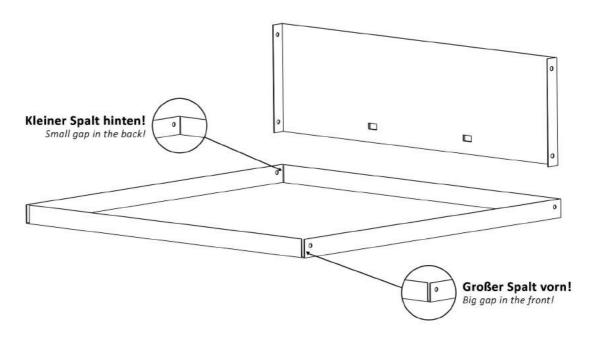
Setzen Sie die Schubladenrückwand (19) auf den Schubladenboden (16). Schrauben Sie die beiden Teile noch nicht zusammen!
