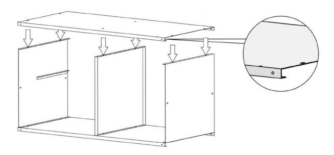
Schrauben Sie jetzt den Deckel (3) auf die Konstruktion. Verschrauben Sie die Mittelwand nun auch mittig mit dem Deckel. Achten Sie darauf, dass der Deckel mit den Kanten nach unten ausgerichet ist!
