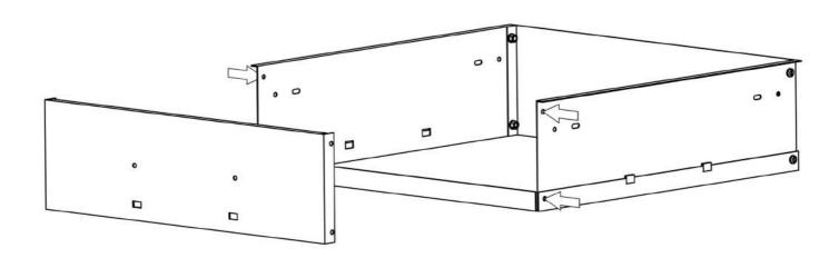
Schrauben Sie die Schubladenfront (15) an die Schubladenseitenwände.
