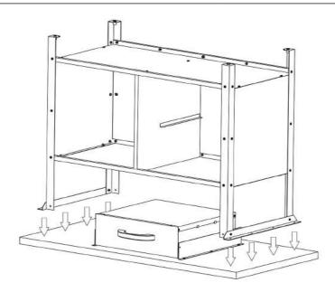
Schrauben Sie den Korpus mit Hilfe von acht Schneidschrauben (25) auf die äußeren Markierungen der Unterseite der Arbeitsplatte (10).
