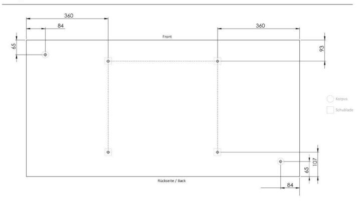
Markieren Sie die benötigten Befestigungspunkte auf der Unterseite der Arbeitsplatte (10).
