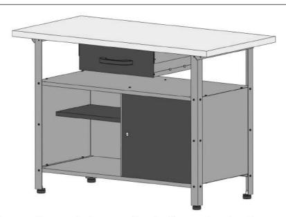
Ziehen Sie zum Schluss noch einmal alle Schrauben kräftig nach. Schrauben Sie die Werkbank an die Wand. Vergewissern Sie sich vor der Wandmontage, ob die gewählten Schrauben und Dübel für Ihre Wand geeignet sind.
