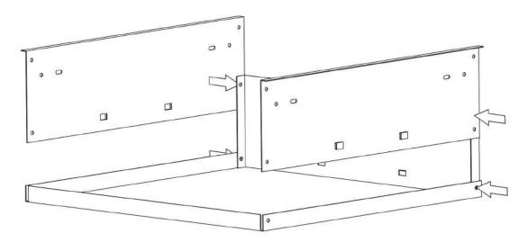
Schrauben Sie jetzt beide Schubladenseitenwände (18), die Schubladenrückwand sowie den Schubladenboden zusammen. Achten Sie beim Verschrauben der Einzelteile darauf, dass die Schraubenköpfe außen sitzen und die Muttern sowie Unterlegscheiben innen sitzen.
