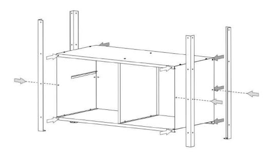
Schrauben Sie die 4 Tischbeine (1) an die Konstruktion.
