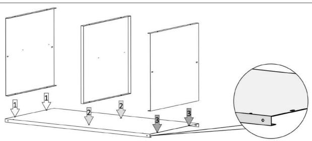
Schrauben Sie mit Hilfe von sechs Schraubensets (23) die Seitenwand 1 (4), die Mittelwand (7) und die Seitenwand 2 (5) an den Boden (3). Achten Sie darauf, dass der Boden mit den Kanten nach unten ausgerichtet ist!
