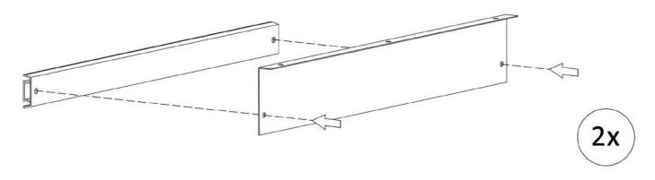
Schrauben Sie je eine Schubladenaufhängung (20/21) mit einer Schubladenführung (17) auf der kantenlosen Seite zusammen.
