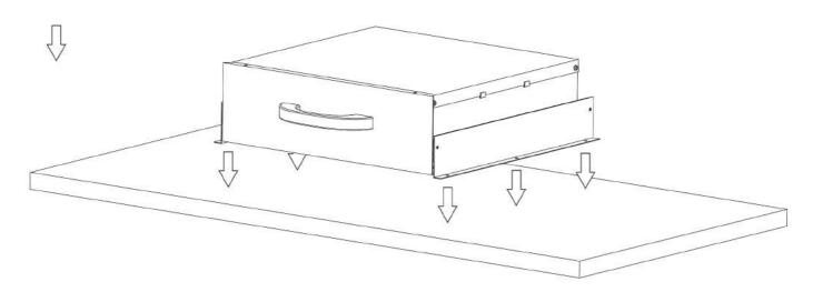
Schrauben Sie die Schubladen-Konstruktion mit Hilfe von sechs Schneidschrauben (25) auf die inneren Markierungen der Unterseite der Arbeitsplatte (10).
