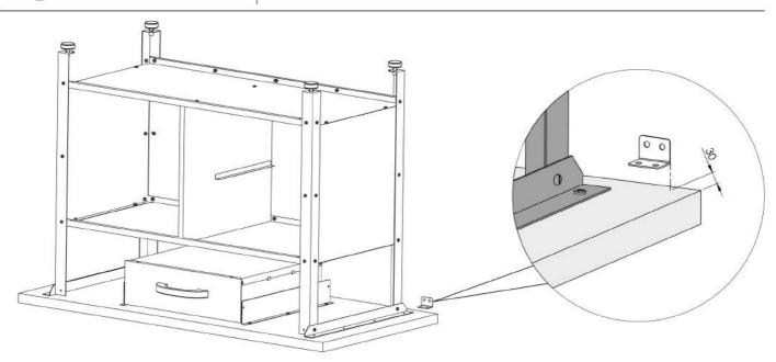
Schrauben Sie die beiden Anbauwinkel (12) mit Hilfe von jeweils zwei Schneidschrauben (25) mit einem Abstand von 30 mm zu den Ecken auf der Rückseite der Arbeitsplatte. Stellen Sie die Werkbank wieder auf.
