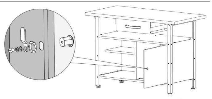
Stecken Sie den Schließzylinder des Schlosses (12) durch die in der Tür vorgesehene Öffnung und fixieren Sie ihn wie in der Abbildung. Prüfen Sie vorher, ob die Schließrichtung korrekt ist.
