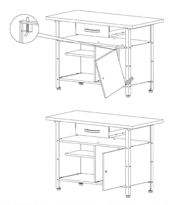
Bringen Sie die Tür in Position zu den Türsplint-Löchern im Werkbank-Korpus und stecken oben und unten je einen Federsplint (27) in die vorgesehenen Türlöcher mit der Feder in der Türsplint-Vorichtung (siehe Detail-Abbildung).
