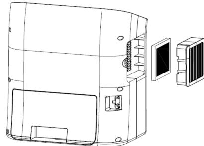
Ziehen Sie das Wasserbecken inkl. des Befeuchtungselements (Abb.1) aus dem Gerät und entfernen Sie die Transportsicherungen im Wasserbecken. Spülen Sie den Wassertank und das Wasserbecken inkl. der Befeuchtungsscheiben gründlich. Trocknen Sie den Wassertank und das Wasserbecken im Anschluss mit einem weichen, trockenen Tuch oder lassen Sie diese lufttrocknen.
