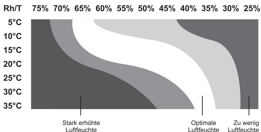
**Achtung:** Auch zu hohe Luftfeuchtigkeit bringt eine Vielzahl negativer Auswirkungen mit sich, wie beispielsweise erhöhte Vermehrung von Keimen, Schimmelbildung oder Kondenswasser an Wänden und Fenstern.
