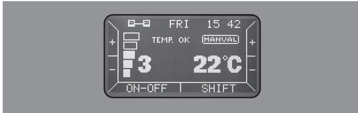
Abb. 4: Display-Anzeige im Stand-by-Betrieb
