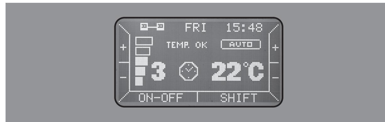
Abb. 11: Display-Anzeige bei Automatikbetrieb
