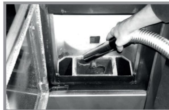
Abb. 12d: Reinigung der Topfhalterung
