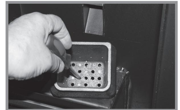
Abb. 12c: Reinigung der Luftöffnungen mit einem Werkzeug
