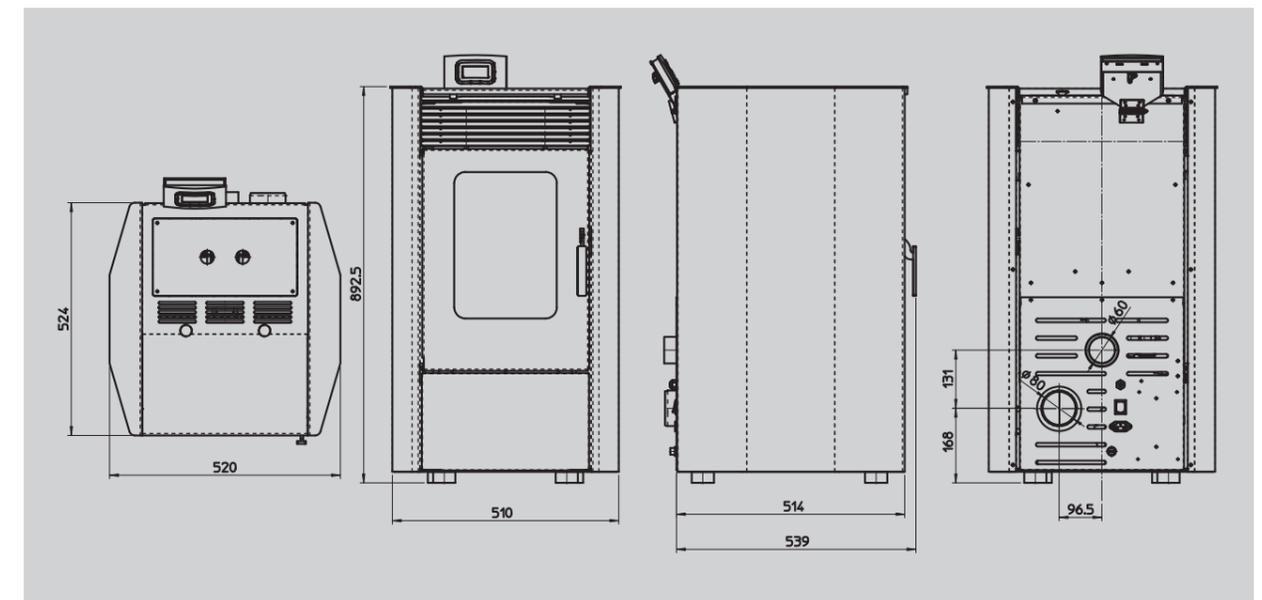
Abb. 1b: Geräteabmessungen (alle Maßangaben in mm)
