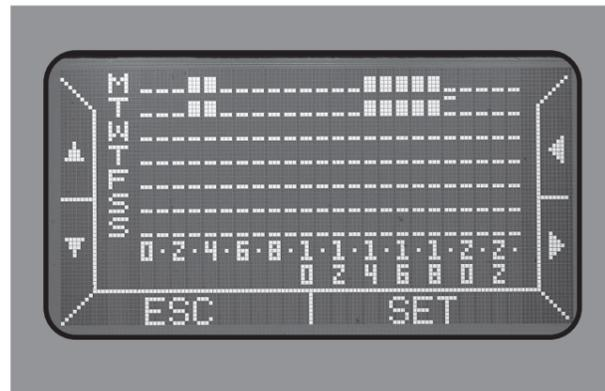
Abb. 9b: Display-Anzeige SET TIMER, programmiert
