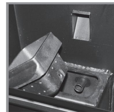
Abb. 6a: Brenntopf einsetzen
