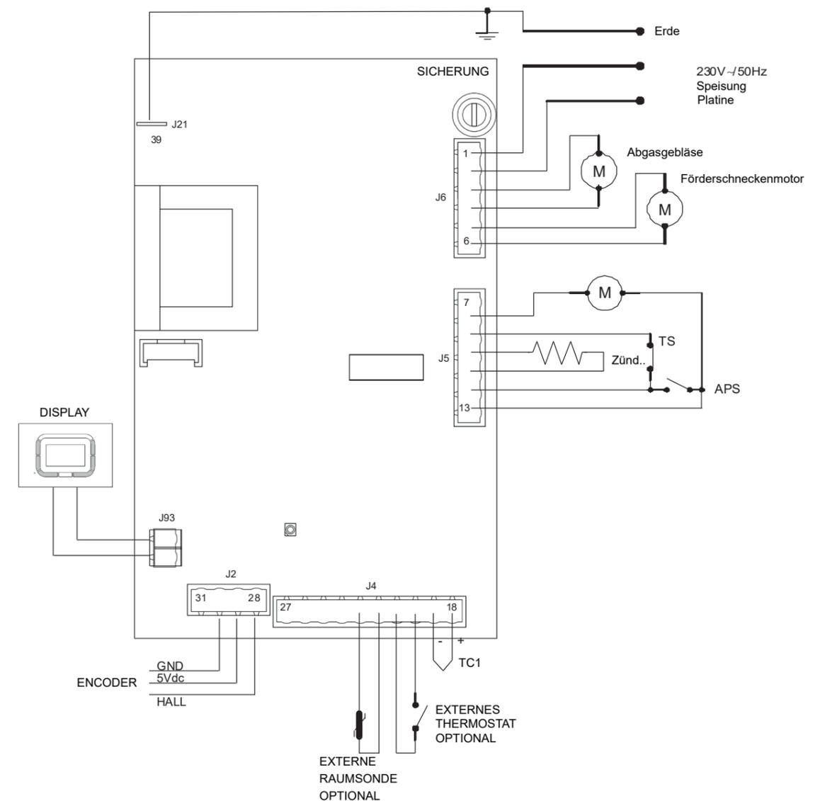
Abb. 15: Schaltplan der Platine
