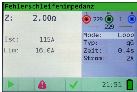
Abb. 14: Messung der Fehlerschleifenimpedanz, Kabelanschluss und Ergebnisse
