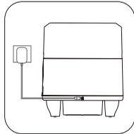
Stecken Sie den Stecker des Netzteils vollständig in den Netzanschluss auf der Rückseite des Geräts.
