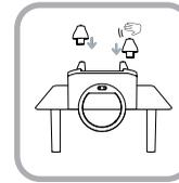
① Entfernen Sie die Trommel und das Zubehör. Legen Sie das Gerät umgedreht auf einen Tisch (siehe Abbildung). Bringen Sie die 4 Stützfüße nacheinander an den dafür vorgesehenen Stellen an. Klopfen Sie leicht, um den sicheren Sitz zu bestätigen.
