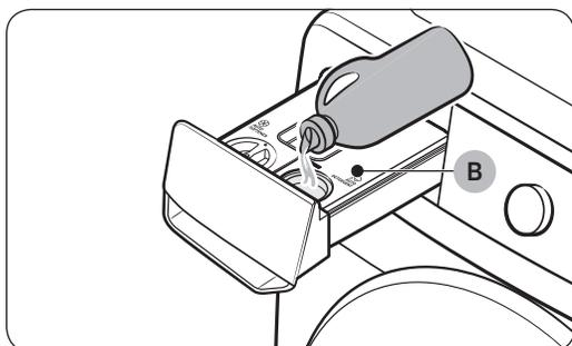
3. Geben Sie eine ausreichende Menge an Waschmittel in das **Fach für automatische Waschmitteldosierung (B)**.
