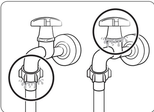
1. Verbinden Sie den Wasserschlauch mit dem Wasserhahn und drehen Sie den Überwurfring dann nach rechts fest.
