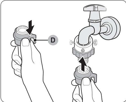
6. Ziehen Sie **Teil (D)** am Wasserschlauch nach unten, und verbinden Sie den Wasserschlauch mit dem Adapter. Lassen Sie **Teil (D)** dann los. Der Schlauch rastet hörbar am Adapter ein.
