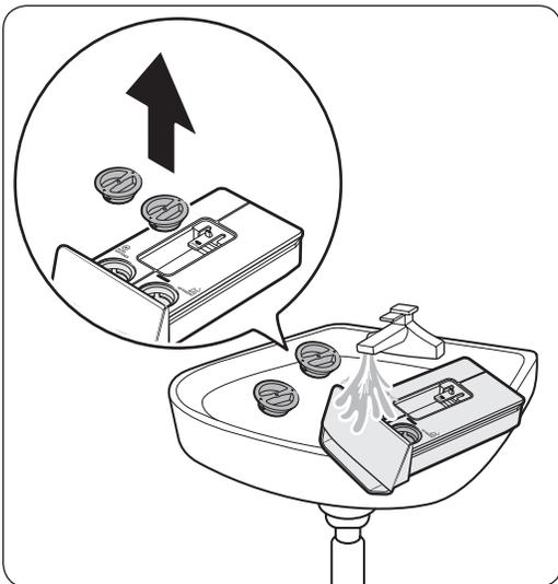
1. Drücken Sie den **Entriegelungshebel** im Innern des Behälters herunter und ziehen Sie zugleich den Waschmittelbehälter heraus.
