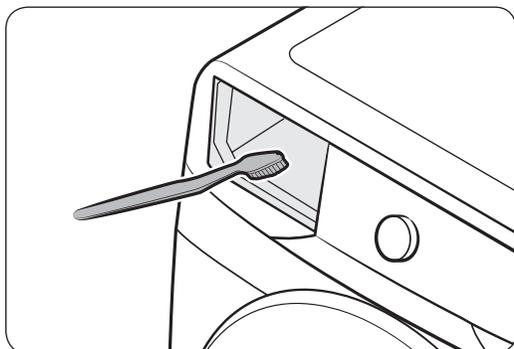
3. Reinigen Sie die Schubladenmulde mit einer Flaschenbürste, um Reinigungsmittelreste und Kalkablagerungen in der Schubladenmulde zu entfernen.
