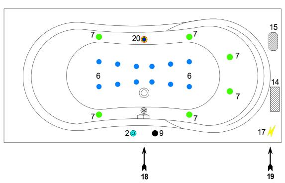
Whirlpool Anschluss: 230 Volt 3 x 1,5mm<sup>2</sup> Querschnitt mit 16 Ampere Absicherung (B16)
