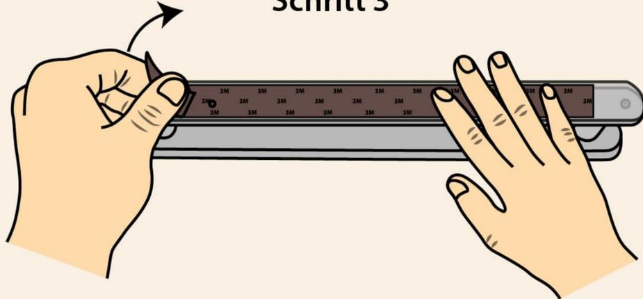
Schutzfolie der angebrachten Klebestreifen abziehen
