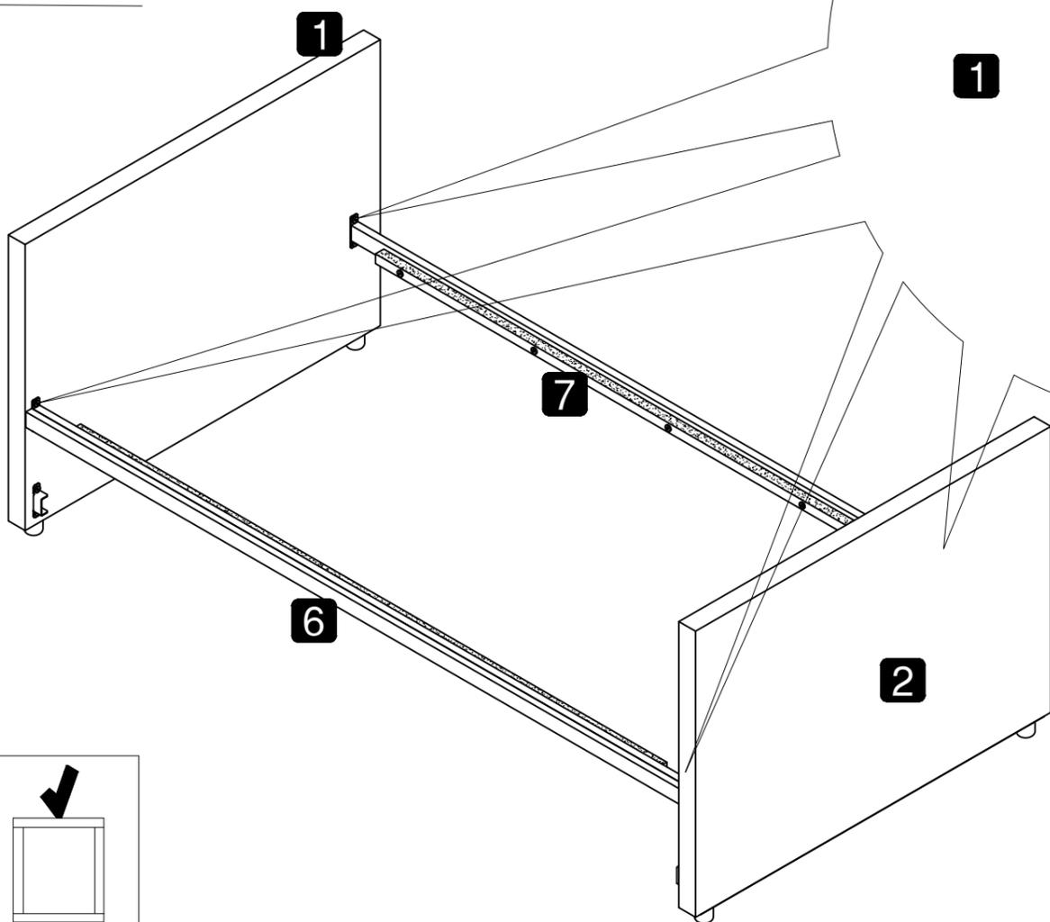
(Verwenden Sie den Sechskantschlüssel (K) und die Schraube (A), um den Bettbalken (6&7) mit dem Handlauf (1&2) zu verbinden. Achten Sie auf die Richtung, wie in der Abbildung gezeigt. Die konvexen flachen Nudeln zeigen nach innen und der Klettverschluss nach oben.)
