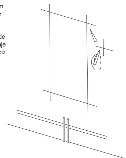
5. Montaje en pared de ladrillo o ladrillo Taladre el agujero con una broca de albañilería de 8 mm en las posiciones de montaje deseadas e introduzca el taco E en el agujero de forma que quede a ras de la pared.
