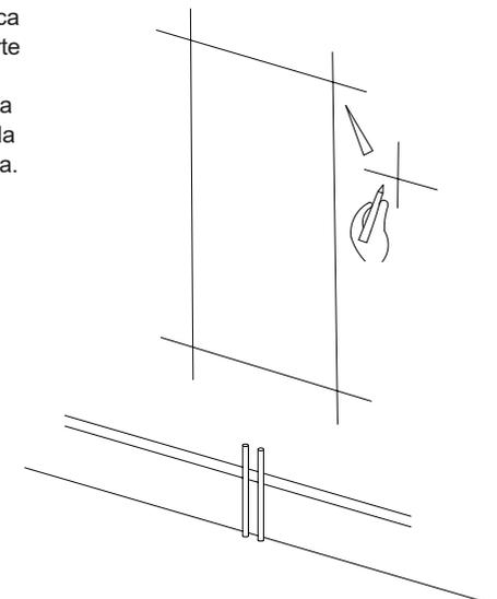
5. Montaggio su parete in mattoni o brise Praticare il foro con una punta da muratore da 8 mm nelle posizioni di montaggio desiderate e inserire il tassello E nel foro in modo che sia a filo con la parete.
