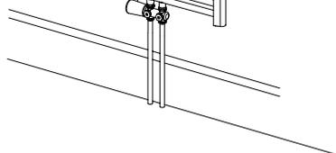
8. Drücken Sie die Schiene flach gegen die Wand, stellen Sie die gewünschte Tiefe ein und ziehen Sie die kleinen Schrauben fest, Schieben Sie die Endkappen über die Halterungsköpfe, bis sie einrasten.
