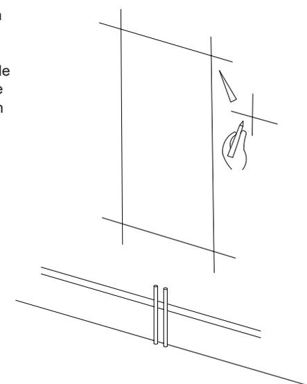
5. Montage sur un mur en brique ou en briques Percez le trou avec une mèche à maçonnerie de 8 mm aux positions de montage souhaitées et insérez la cheville murale E dans le trou de manière à ce qu'elle affleure le mur.
