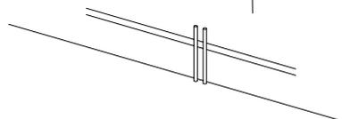
6. Placez l'entretoise H dans le support mural et insérez la petite vis G dans le trou du support mural. Ne serrez pas trop pour permettre des ajustements ultérieurs.
