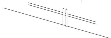
6. Posizionare il distanziale H nel supporto a parete e inserire la piccola vite G nel foro del supporto a parete. La vite G va inserita nel foro della staffa a parete. Non serrare eccessivamente per consentire regolazioni successive.
