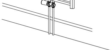
8. Appuyez le rail à plat contre le mur, ajustez à la profondeur désirée et serrez les petites vis, faites glisser les embouts sur les têtes des supports jusqu'à ce qu'ils se verrouillent en place.
