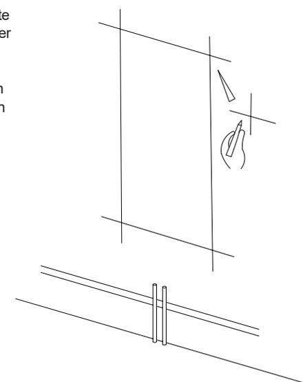
5. Montage am Backstein oder Brisenmauer Bohren Sie an den gewünschten Befestigungspositionen das Loch mit einem 8mm Steinbohrer und setzen Sie den Wandstopfen E so in das Loch ein dass er bundig mit der Wand abschließt. Setzen Sie die lange Schraube F durch die Mitte der Wandhalterung D und ziehen Sie die am Dübel fest.
