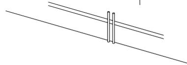
6. Platzieren Sie den Abstandshalter H in der Wandhalterung und setzen Sie die kleine Schraube G in das Loch in der Wandhalterung ein. Nicht zu fest anziehen, um spätere Anpassungen zu ermöglichen
