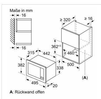
Maße in mm Montage einer 20-I-Mikrowelle in einem Hängeschrank
