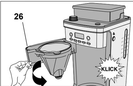
3. Schließen Sie die Blende (26) der Filtereinheit.
