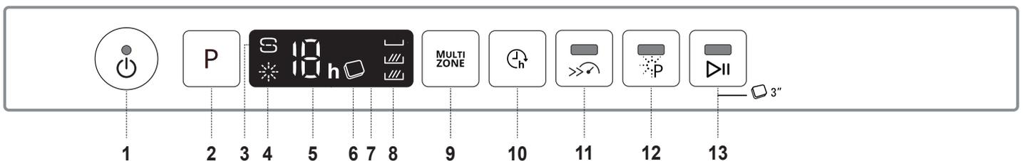
1. Ein-Aus/Reset Taste mit Anzeigelicht
