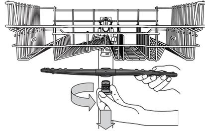
Zur Abnahme des oberen Sprüharms drehen Sie den Kunststoffring gegen den Uhrzeigersinn ab. Der obere Sprüharm ist mit jener Seite nach oben wieder einzusetzen, die die meisten Löcher aufweist.
