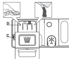
1. Hinsichtlich der Dosierung verweisen wir auf die zuvor erwähnte Information, in der die richtige Menge angegeben ist. Im Fach **D** sind Anzeigen die bei der Spülmitteldosierung helfen.
