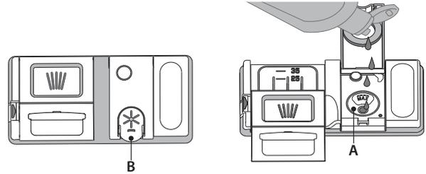
1. Den Behälter **B** durch Drücken und Anheben der Zunge am Deckel öffnen.
