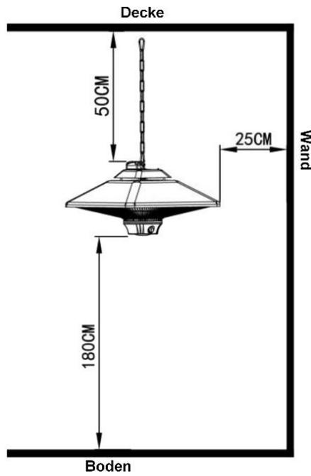
2. Befestigen Sie nun die mitgelieferte Befestigungskette am Halterungshaken, indem Sie ein Ende der Kette mit einem Karabiner im Halterungshaken einhängen.
