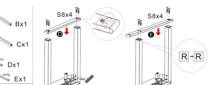
senkrecht zur Verbindungsstange stehen. Und dann alle Schrauben festziehen. S1x10 Gx1 A
