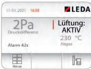
Abb. 7.3 Anzeige bei einer Störung
