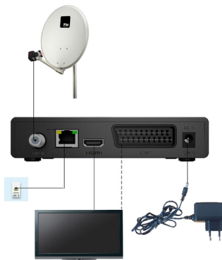
Beispiel 3 – System mit LAN-Verbindung
