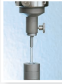
Test Nietdornausdrückkraft Mandrel push out test Essai de retenue de la tête de rivet
