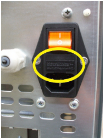
Fig. 88 - Abdeckklappe mit Sicherungen, die ausgetauscht werden müssen
