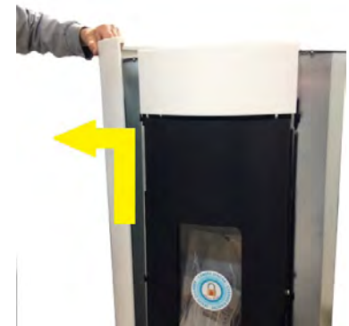
Fig. 75 - Entfernen der Seiten
