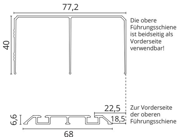
Sofern Sie die Bodenschiene **vor** Fertigstellung der Türflügel montieren wollen, können Sie sich an diesem Maß orientieren. **Wir empfehlen aber, die Schiene auszuloten, wie in Schritt 9 beschrieben.**
